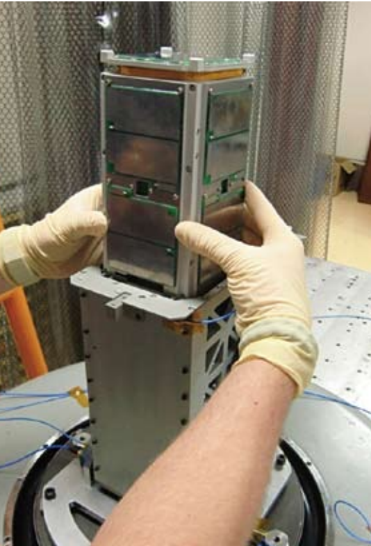
立方衛星由於較簡單，成本也較低，很適合做為教學平台。上方照片中，PACE團隊的學生成員正將PACE立方衛星工程體置入彈射英艙，準備利用震動平台進行震動測試。
